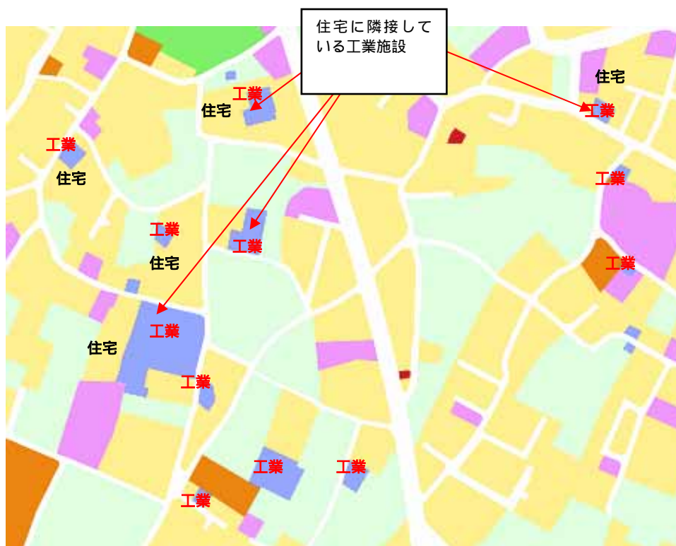
図 住工混在の例
