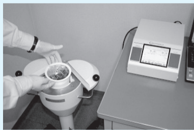
▲給食食材の放射性物質検査
