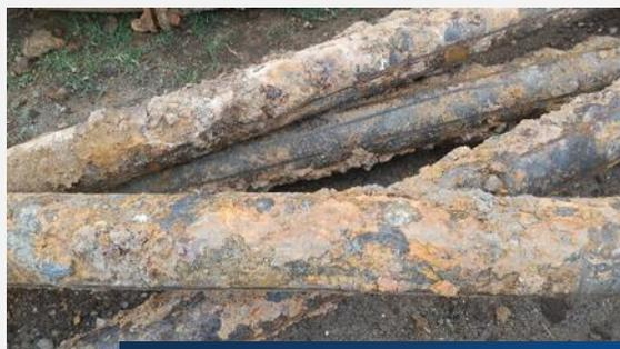
老朽化により腐食した鋳鉄管
