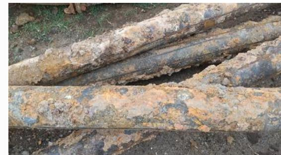
老朽化により腐食した鑄鉄管
