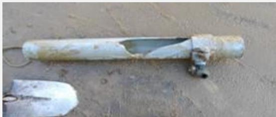
老朽化により破損した塩化ビニル管
