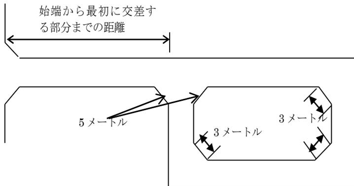
例図8-1 袋路状道路の延長距離が70メートルを超える場合における当該道路の区間距離70メートル以内ごとに設置する転回広場の例（延長距離が100メートルの場合）
