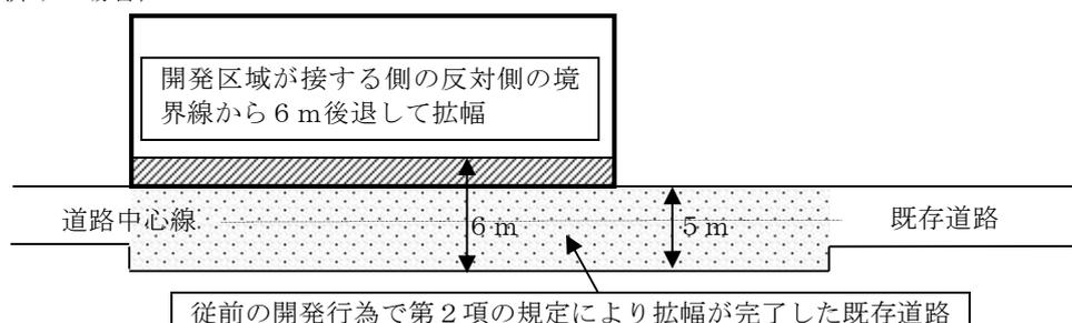
例図 7-2 第 21 条第 5 項による拡幅を要しない開発行為の例
