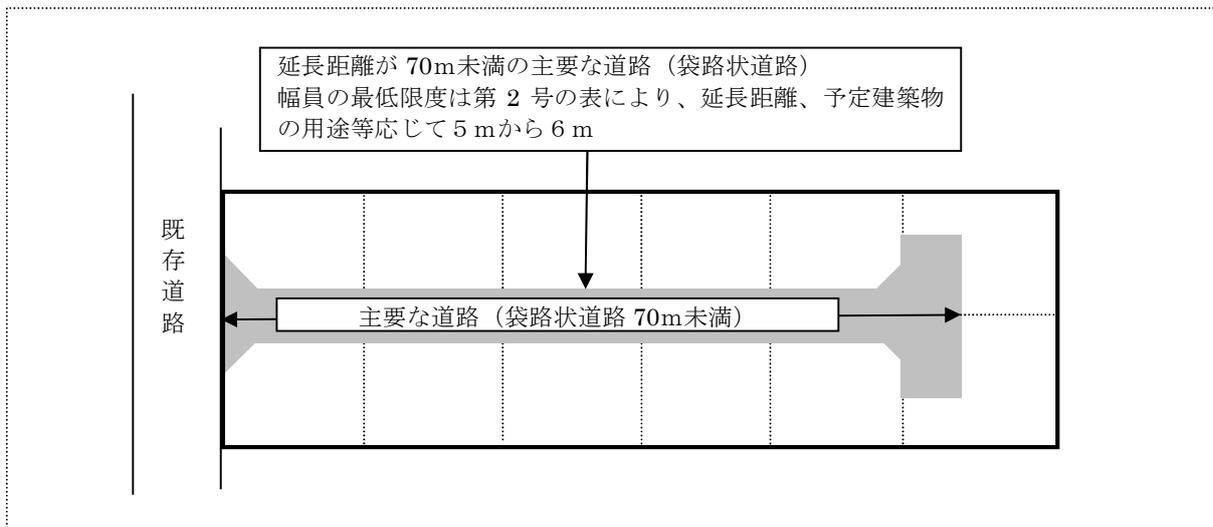
例図 2-3 条例第 11 条第 1 号及び第 2 号に規定する道路以外の道路の例 条例第 11 条第 3 号
