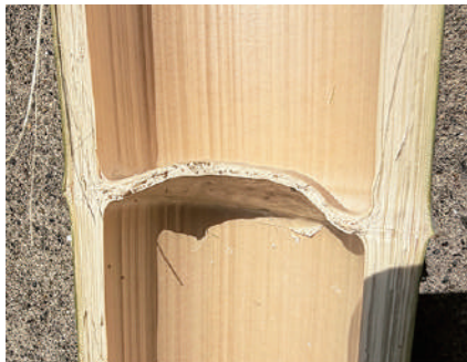
⑦ 節の部分には風や雪で折れないように強度を高める仕切りのような構造がある
