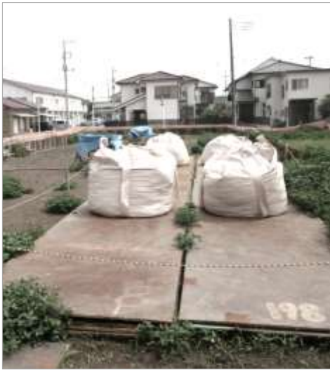
<実証実験の様子> 鉄板と大型土のうで住宅の重さを再現して、沈下量を測定しました。
